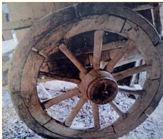
Rueda de los denominados "carros blancos" que, armada con maza, radios y aros en madera, evidencia el ingenio de los carreteros de la época.
